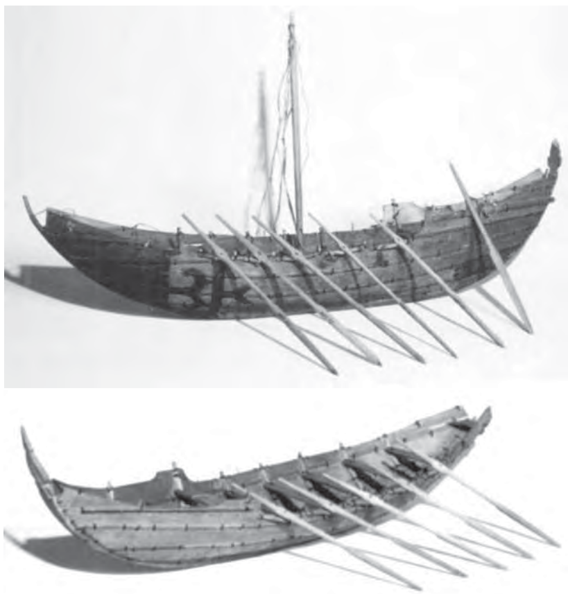
Рис. 29. Модели парусных дощатых лодок айнов Курильских островов. МАЭ РАН (№ 809-10, 22). Источник: [Айнские коллекции 1998: 23, 24]
