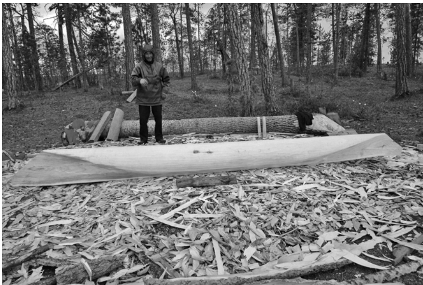
Рис. 9. Алексей Кириллович Кунин за изготовлением лодки-долбленки. Красноселькупский район Тюменской области. 2015 г. Фото автора
