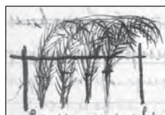
Рис. 88. Конструкция стены хижины Кренака из листьев пальмы
