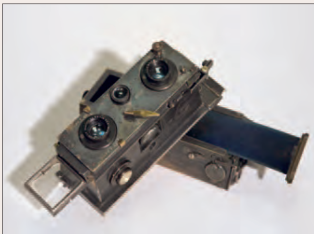
Рис. 2. Ручной стереоскопический фотоаппарат «Вераскоп» фирмы «Ришар» (Париж) для пластинок формата 4,5 \times 10,7 см. Объективы с большим относительным отверстием F: 4,5 и затвором Хрономос. Модель 1908 г. Музей истории фотографии (Санкт-Петербург). Фото Д. С. Шнеерсона. С любезного разрешения музея
