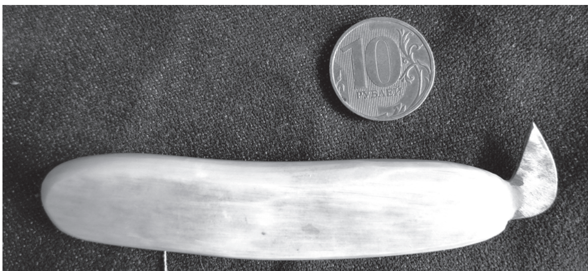
Рис. 31. Инструмент для современного ручного гравирования моржового клыка: «коготок» — клювовидный резец. Фото Дмитрия Широкова
