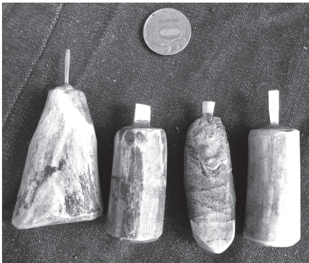
Рис. 32. Инструмент для современного ручного гравирования моржового клыка: набор «рифелей» с различной шириной рабочего края. Фото Дмитрия Широкова
