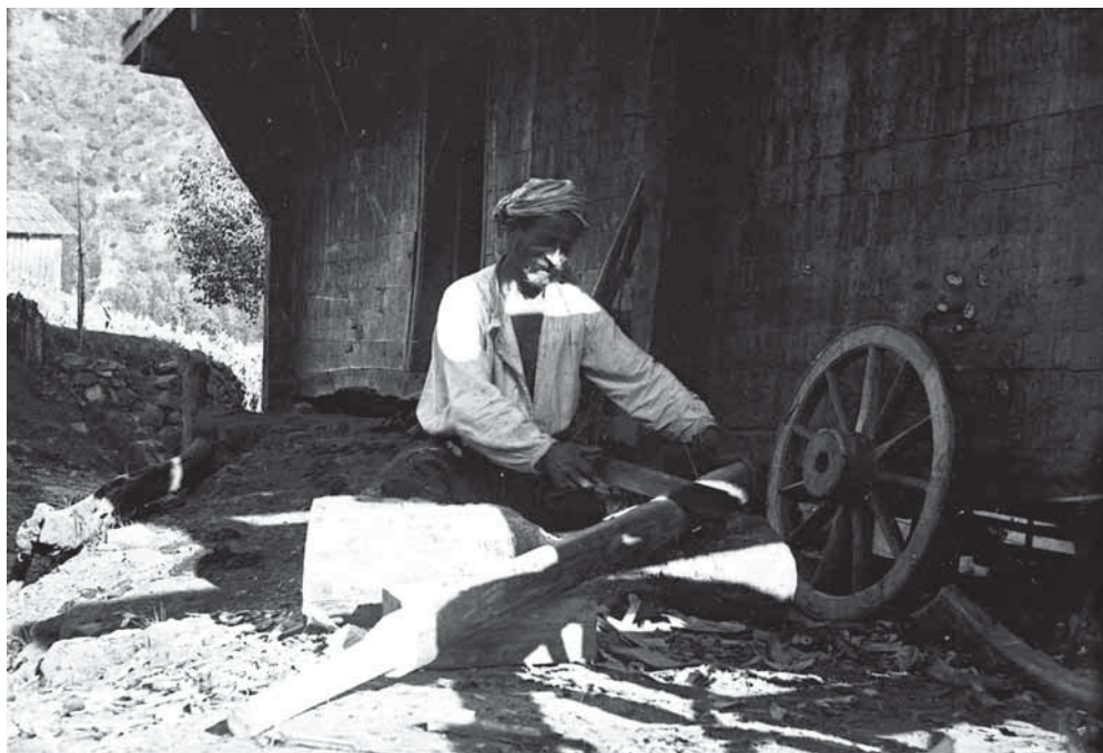
Рис. 8. Аджарец Дауд Болквадзе за изготовлением повозки сели (пилит ось). МАЭ. Колл. № И-1774-8
